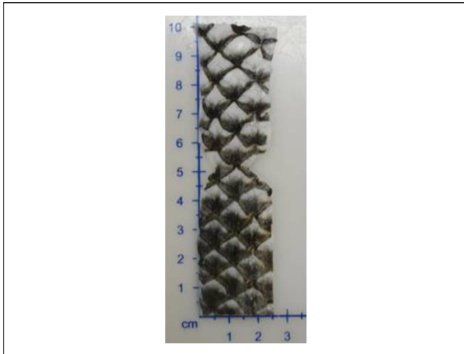
Figura 2 - Corpo de prova para o ensaio de tracionamento medindo 10,0 x 2,0 cm (altura x largura) mostrando região central em forma de ampulheta com 1,0 cm de largura.
